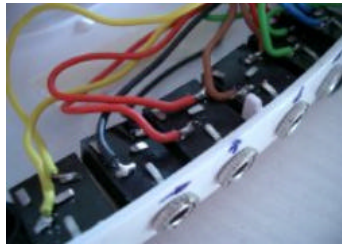
5. Soldar cables a los conectores
