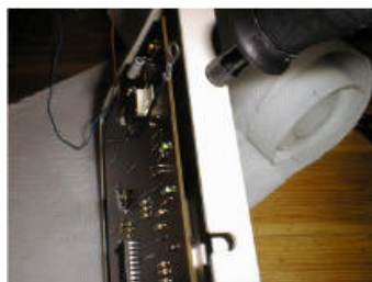
8. Fijar la clavija a la carcasa. Cerrar la carcasa y conectar el pulsador
