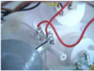
4. Soldar cables a puntos de contacto
