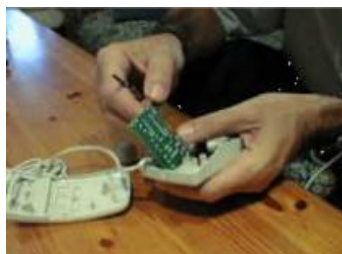
2. Acceder al circuito impreso y localizar los puntos de soldadura
