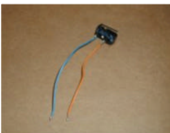
1. Soldar cables y clavijas al microinterruptor
